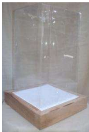
Fig. 1. Modelo de invólucro de proteção confeccionado com base de madeira, foamboard revestido com Tyvek® e folha de poliéster.
