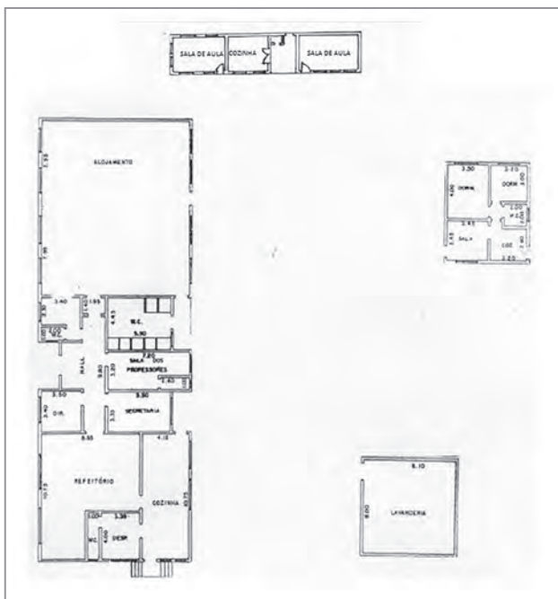
Figura 2 – Prédio central, Galpão externo com as duas Salas de Aulas, Lavanderia e Casa do Zelador.
